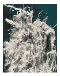
▲ FIGURE 22.35 Serpentine asbestos.
